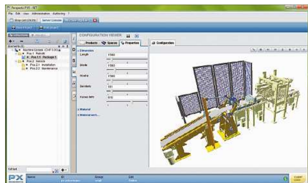
3D-Visualisierung sowie interaktive Benutzerführung in «P'X5» erleichtern die Abbildung bestehender Maschinen sowie die notwendige Umsetzung von Änderungen und Ergänzungen.
